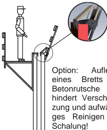
Option: Auflegen eines Bretts als Betonrutsche verhindert Verschmutzung und aufwändiges Reinigen der Schalung!
