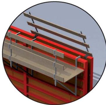
Sicheres und einfaches Einschieben der Seitenschutzbretter, der Arbeiter muss sich nicht nach vorne über die Absturzkante beugen. Eine Einheit aus 2 Geländerhaltern und 3 Seitenschutzbrettern darf nicht durch Überlappung der Bretter mit der nächsten Einheit verbunden sein.
