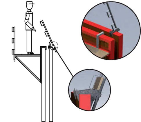
Einstecken der Steck-Geländerhalter in das schwenkbare Einsteckrohr. Unterer Bügel wird seitlich gehalten, dadurch automatische Verdrehsicherung und einfaches Einschieben der Seitenschutzbretter.
