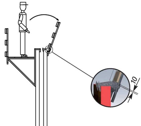
Schwenken der verbundenen Einheiten nach aussen, beim Schwenkvorgang wird das Rahmenprofil der Wandschalung umgriffen und eine kraftschlüssige Verbindung hergestellt. In der Endposition rutscht der Geländerhalter durch die Schwerkraft nach unten und sichert automatisch die Kralle gegen ein unbeabsichtigtes Lösen. Dadurch wird die sichere Absturzsicherung auf einfache Art und Weise gewährleistet!
