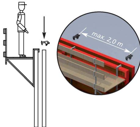
Aufstecken der FS-Kralle auf die Schalung. Einsteckrohr für den Geländerhalter muss in Richtung zum Arbeiter hin zeigen (offene Stellung).
